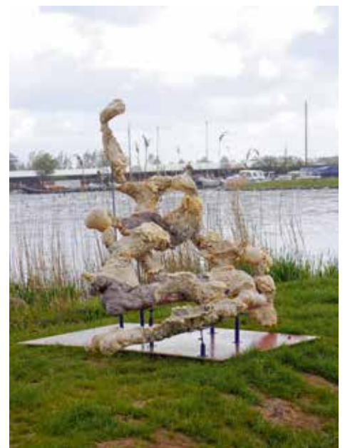
Abb. 5: Modell eines ausgegossenen Bissambaus im Deich
